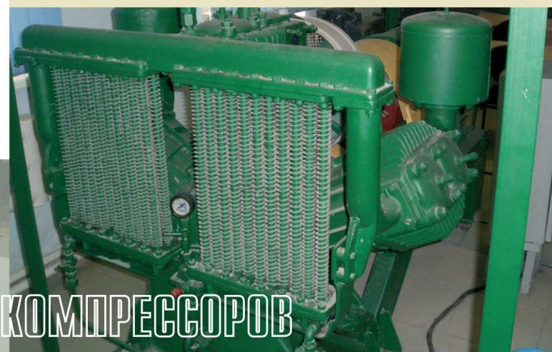
**СТЕНД ДЛЯ ИСПЫТАНИЯ КОМПРЕССОРОВ**
