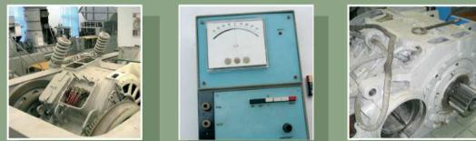
Прибор предназначен для обнаружения без разборки короткозамкнутых витков любой обмотки электрической машины, имеющей отдельные выводы, включая трансформаторы.
